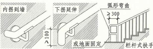
扶手内测与墙面距离不应小于40; 扶手截面直径或宽度应为35~50; 安装在墙面的扶手与托件宜为L形连接。如下图:
