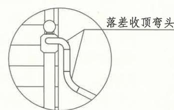
注：本图为当楼梯转折处踏步没有按照1-9页进行调整设计时，楼梯扶手转折处可用各种弯头连接的示意。 $H$ 为踏步前缘至扶手的顶的高度。
